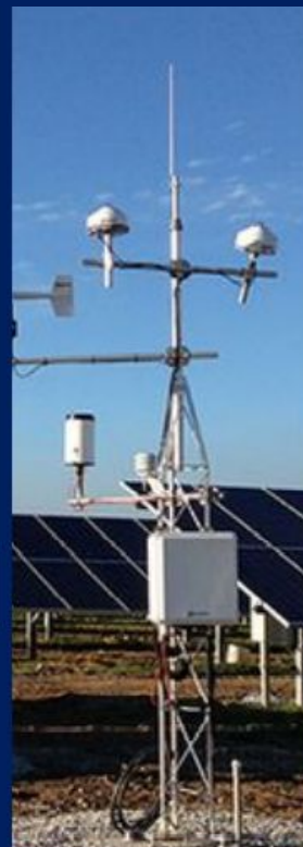
Modulo radio (destra) per la comunicazione tra sensori, stazione meteo (sinistra), e unità di controllo
