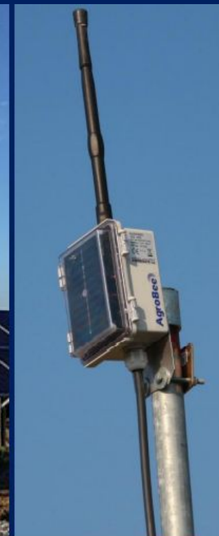
Modulo radio (destra) per la comunicazione tra sensori, stazione meteo (sinistra), e unità di controllo
